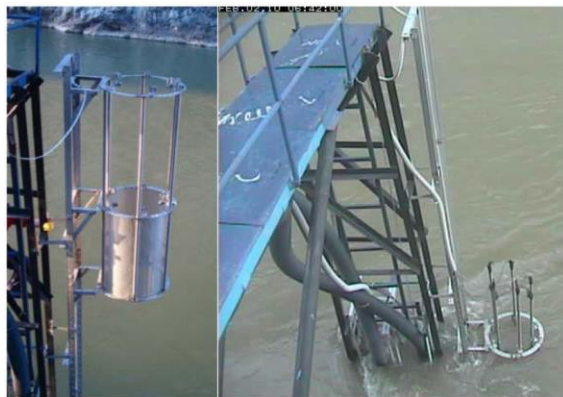
Gambar 43. Unit LMS yang Dibenamkan dalam Sungai
